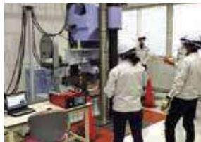
国内最大級・最新鋭の万能試験機を用いた実験風景
